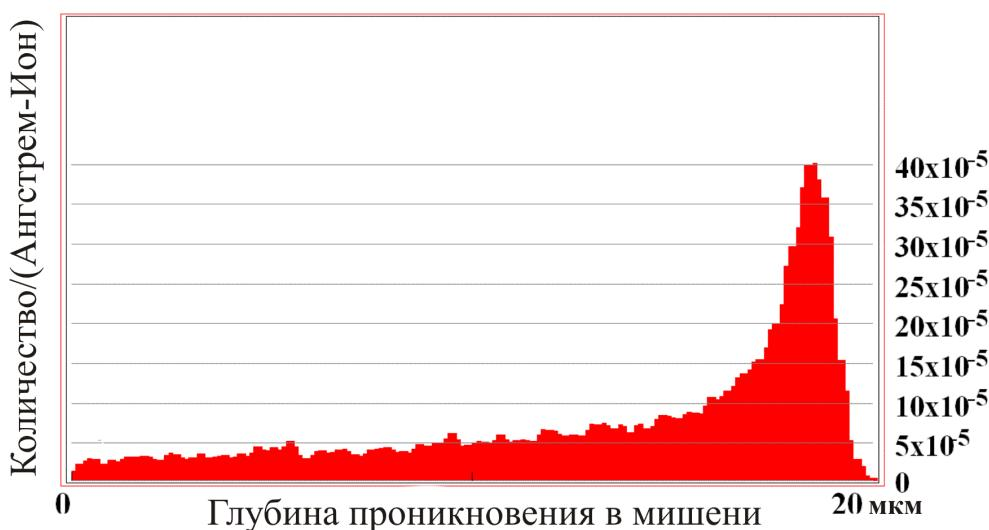
Рис. 4.1. Численное моделирование распределения генерируемых вакансий при прохождении 2 МэВ-ных протонов в меди [144]
