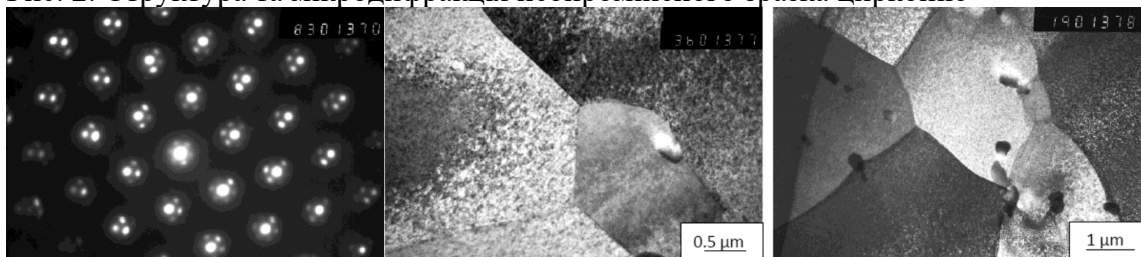
Рис. 3. Структура та мікродифракція опроміненого зразка цирконію
