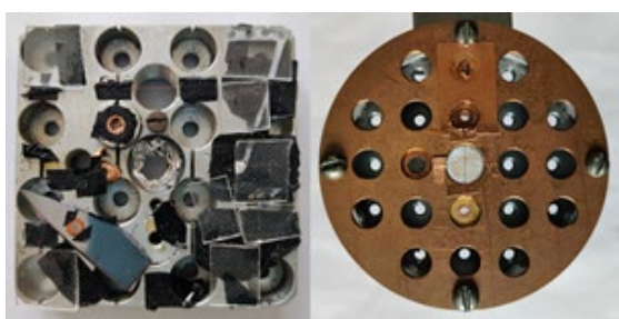
Рис. 1. Зовнішній вигляд старого (ліворуч) та нового (праворуч) тримача зразків в камері взаємодії.
