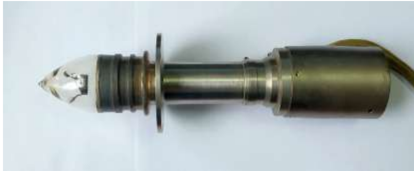
Рис. 1. Радіочастотний мас-спектрометр ІВА-1М
